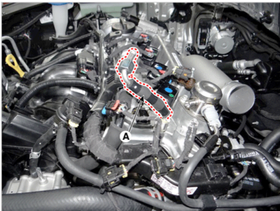
8. 拧下固定螺栓(A)，从气缸盖总成上拆卸高压燃油泵。
